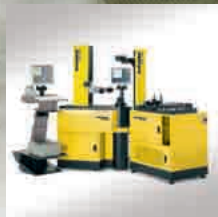
GISS 5000: Werkzeugvoreinstellung, Schrumpfen und Messen mit einem intelligenten Schrumpfgerät
